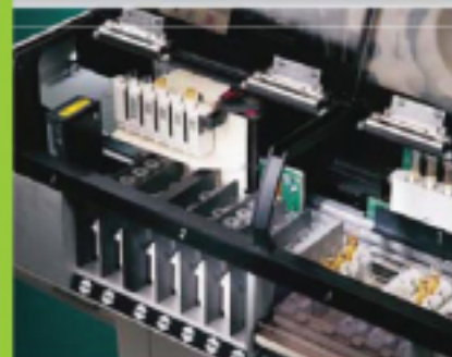
Las bahías de prioridad RSH permiten el acceso del tubo de muestra STAT en 2 minutos o menos
